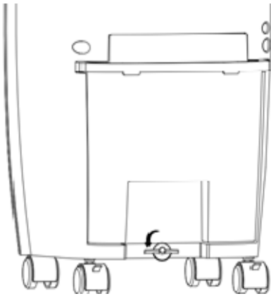
Ouverture du réservoir
