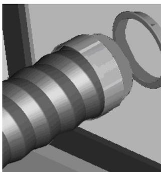
4. Pendant les périodes de non-utilisation, débrancher le tuyau et fermer le hublot avec le bouchon.
