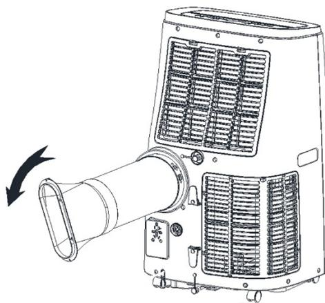
Conectar a la parte final del tubo flexible el empalme circular para ventana (1) y luego el empalme terminal para ventana
