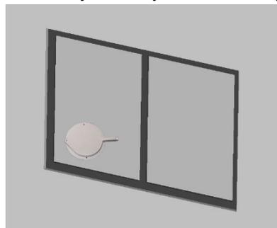
3. Poner el ojo de buey sin el tapón de cierre en la ventana. Colocar el empalme circular para kit ojo de buey en el tubo flexible retráctil e colocar el tubo flexible retráctil con empalme circular en el ojo de buey.
