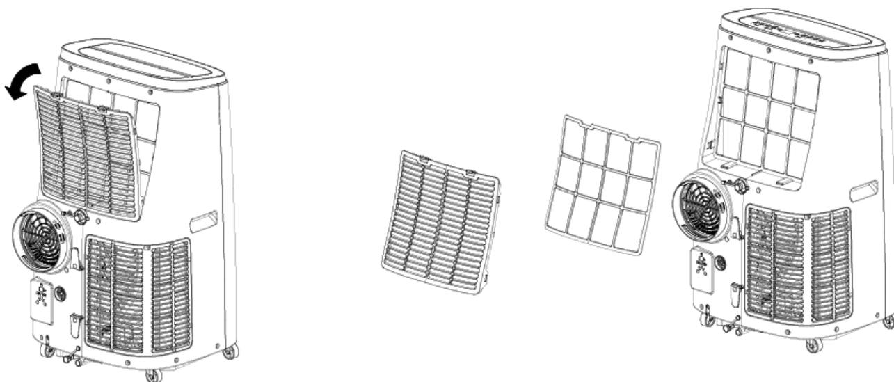
Utilizar una aspiradora para eliminar el polvo. Si no fuera suficiente, lavarlo con agua tibia y a lo sumo detergente neutro; enjuagarlo con agua fría y dejarlo secar naturalmente antes de volver a montarlo. Una vez instalado, cerrar la rejilla y reanudar el uso del climatizador.
