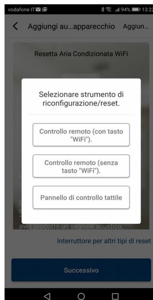
Una volta eseguito il reset secondo le istruzioni, cliccare su *Successivo* per aggiungere automaticamente l'unità (è necessario inserire la password del Wi-Fi).
