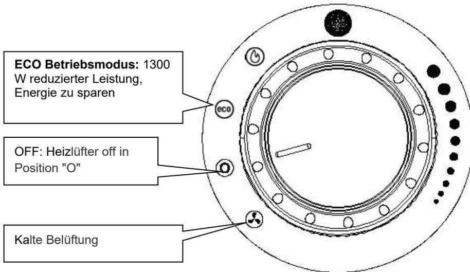
Der Thermostat schaltet den Heizlüfter automatisch ein und aus und sorgt somit dafür, dass die Raumtemperatur auf dem gewünschten Wert bleibt. Je weiter der Drehgriff gegen den Uhrzeigersinn gedreht und auf einen höheren Wert gestellt wird, desto höher ist gewährleistete Temperatur.
