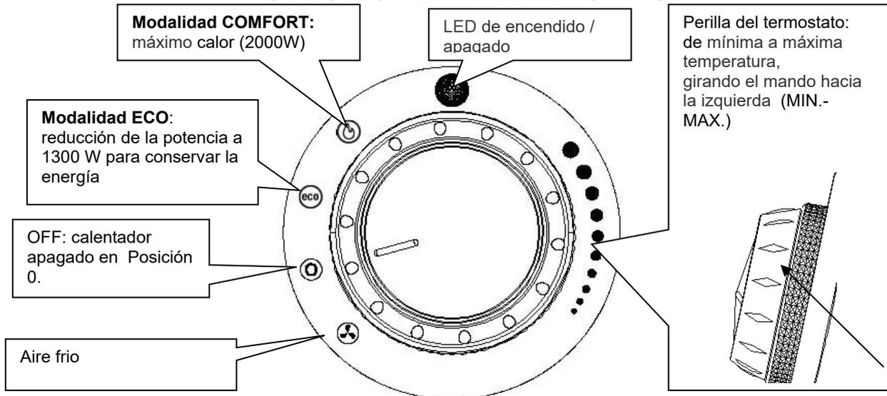
El termostato mantiene la temperatura deseada de la habitación encendiendo y apagando el aparato automáticamente.
