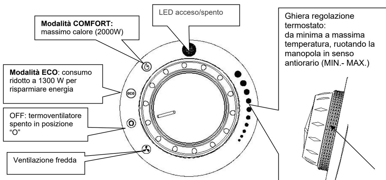
Il termostato mantiene la temperatura ambiente desiderata accendendo e spegnendo automaticamente il termoventilatore. Più la manopola è ruotata in senso antiorario, più la temperatura assicurata sarà elevata.
