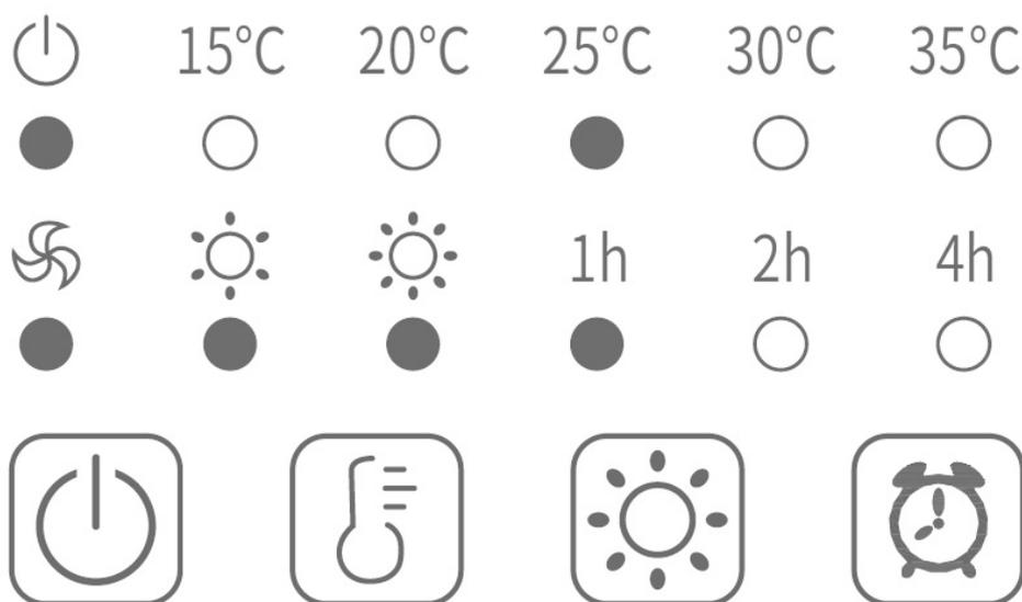
Dopo aver collegato il cavo di alimentazione, il termoventilatore entra in modalità Stand-by e l'icona accende sul pannello di controllo.
