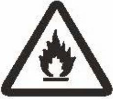
Das Innengerät ist mit brennbarem Gas R32 eingefüllt
