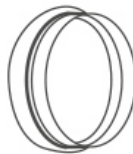
Runder Beschlag für Bausatz Bullauge, das zwischen positioniert werden soll letzten Teil der Röhre und das Bullauge
