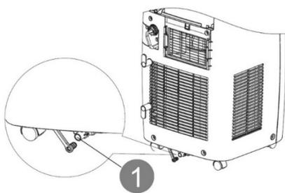
Cuando la unidad funciona en Refrigeración y Calefacción, comprobar que el tapón de goma del orificio de salida posterior esté bien puesto.
