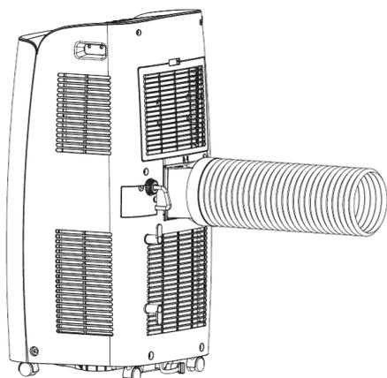
Conectar a la parte final del tubo flexible el empalme circular para ventana (1) y luego el empalme terminal para ventana
