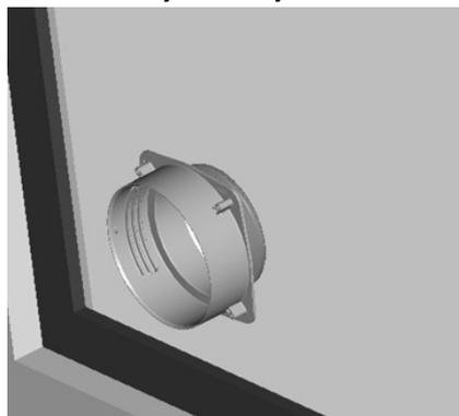
3. Poner el ojo de buey sin el tapón de cierre en la ventana. Colocar el empalme circular para kit ojo de buey en el tubo flexible retráctil e colocar el tubo flexible retráctil con empalme circular en el ojo de buey.
