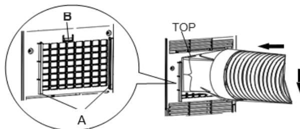
7. La altura del tubo de descarga debe estar entre 40 cm y 130 cm del suelo. Evitar curvas demasiado cerradas o pliegues del tubo flexible.
