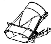
Empalme plano para colocarse entre la boca de expulsión del aire y el tubo flexible
