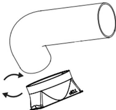
6. Introducir el empalme plano desde arriba hacia abajo en las ranuras (A) y fijarlo con el gancho (B). El lado del empalme que va hacia arriba está marcado con la indicación TOP.
