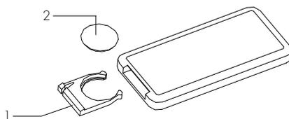
Utilice una pila de botón de litio/manganeso, modelo no. CR2025 -3 V (suministrado), conforme a la Directiva sobre baterías n. 2006/66/CE y modificaciones de la Directiva 56/2013/UE.
