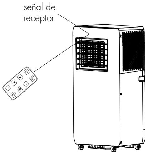
Asegúrese de dirigir el control remoto hacia el receptor de señal ubicado en la parte frontal del aparato, como se muestra en la figura.
