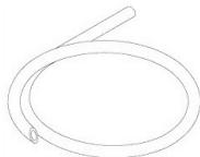
Kondenswasserablaufrohr zum Entleeren
