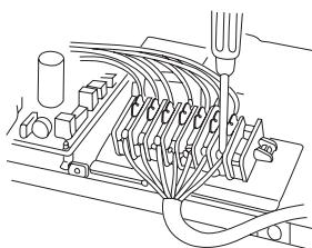
**E** Colocar el cable eléctrico y concitarlo al tablero de bornes (véase esquema de conexiones). Bloquear el cable a la abrazadera de la brida.
