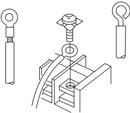
**D** Das elektrische Kabel für die Klemmbrett-Verbindung vorbereiten und sie verbinden. (Siehe elektrische Angaben).
