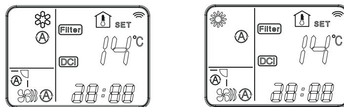
Maintenant appuyer en même temps sur les boutons FAN + I FEEL pendant plus de 7 secondes et les relâcher en pointant la télécommande vers le récepteur de l'unité intérieure. Assurez vous d'envoyer le signal à une seule unité intérieure et qu'il n'y a pas d'autres unités intérieures qui pourraient recevoir le même signal. Si le signal est reçu, l'unité intérieure émet 5 bip consécutives.
