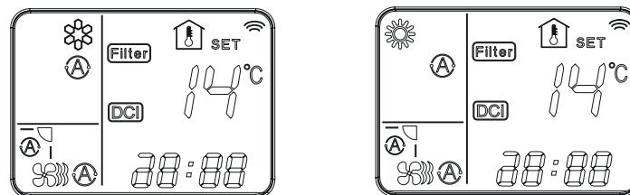
Jetzt, drücken Sie gleichzeitig die Taste FAN + I FEEL während mehr als 7 Sekunden und lassen Sie sie, indem Sie die Fernbedienung auf den Empfänger der Inneneinheit richten. Vergewissern Sie sich, daß das Signal nur zu einer Inneneinheit gesendet wird und daß es keine andere Inneneinheit gibt, die das gleiche Signal empfangen könnte. Wenn das Signal wird empfängt, macht die Inneneinheit 5 aufeinander folgende Signaltöne.
