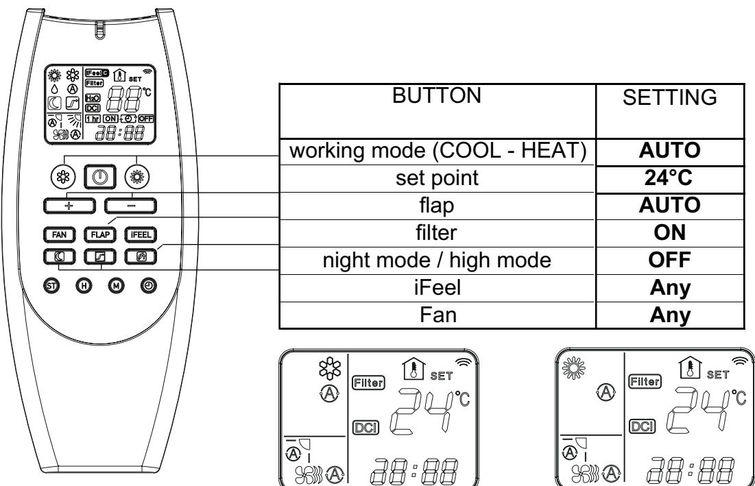
Appuyer en même temps sur les boutons FAN + I FEEL pendant plus de 7 secondes et les relâcher en pointant la télécommande vers le récepteur de l'unité intérieure. Assurez vous d'envoyer le signal à une seule unité intérieure et qu'il n'y a pas d'autres unités intérieures qui pourraient recevoir le même signal.
