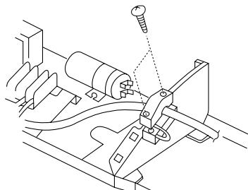
**F** Préparer les câbles électriques pour le branchement dans la boîte à bornes et les connecteur. (Voir schéma pour le branchement). Serrer les câbles d'alimentation à la bague de serrage de la bride.
