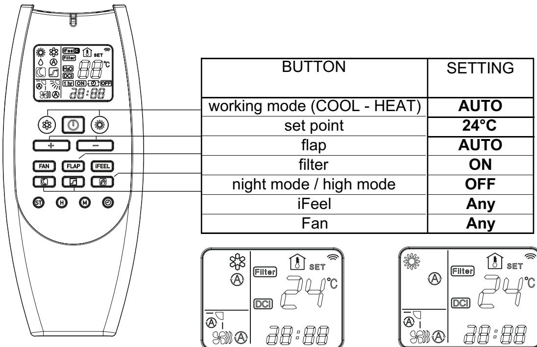
Drücken Sie gleichzeitig die Taste FAN + I FEEL während mehr als 7 Sekunden und lassen Sie sie, indem Sie die Fernbedienung auf den Empfänger der Inneneinheit richten. Vergewissern Sie sich, daß das Signal nur zu einer Inneneinheit gesendet wird und daß es keine andere Inneneinheit gibt, die das gleiche Signal empfangen könnte.
