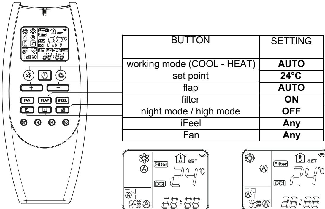
Presionar simultáneamente los pulsadores FAN + I FEEL durante mas de 7 segundos y soltarlos dirigiendo el mando a distancia hacia el receptor de la unidad interior. Asegúrese de enviar la señal a una sola unidad interior y que no hay otras unidades interiores que podrían recibir la misma señal.
