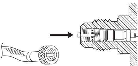
A válvula de serviço da torneira da unidade exterior é utilizada para esvaziar o sistema, enchê-lo com carga refrigerante e para medir a pressão durante o funcionamento. Esta válvula é de tipo "Schrader". É portanto necessário utilizar uma mangueira com pino de impulso.
