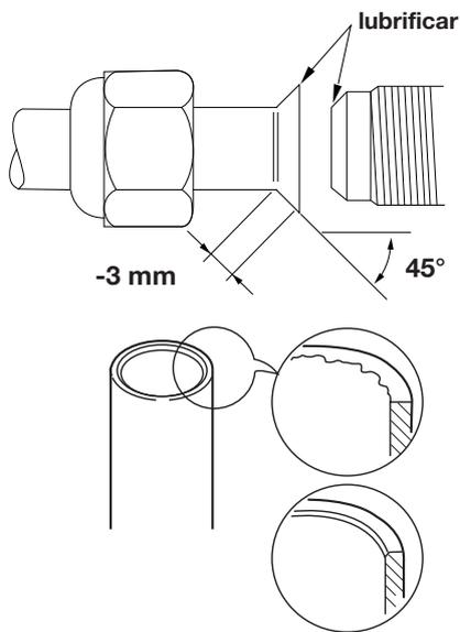
**H** Aperte bem essa ligação usando uma chave inglesa e uma chave dinamômetro seguindo as especificações da seguinte tabela.
