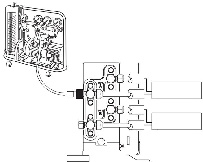
**K** Ligue as unidades interiores usando, se necessário, o adaptador sobre as válvulas de baixa pressão. Extrair as tampas das válvulas de ambos os tubos. Ative a bomba de vácuo por um tempo determinado segundo a tabela (vácuo 10 mm Hg abs.).
