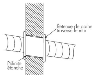
**Remarque:** le diamètre du trou appliqué au mur est généralement de  $\Phi 60$  mm ~  $\Phi 80$  mm. Évitez les câbles et autres tuyaux dissimulés lors de la réalisation du trou.
