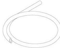
Schlauch für Kondenswasserablass (Dauerabfluss).
