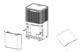
Veillez à ne pas endommager le flotteur et le rivet de verrouillage, qui se trouvent à l'intérieur du réservoir, sinon l'appareil ne s'arrêtera pas automatiquement de fonctionner lorsque le réservoir d'eau est plein, et l'eau pourrait s'écouler et risquer de mouiller le sol du réservoir et d'endommager l'appareil.
