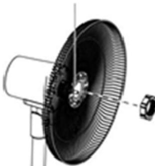
2. Insérer la grille arrière sur l'arbre moteur dans la position correcte. Visser l'écrou pour la fixation de la grille arrière fermement.
