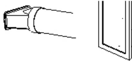
3. Öffnen Sie das Fenster und sperren Sie einen der beiden Fensterflügel mit dem Griff. Setzen Sie den Endanschluss am feststehenden Flügel auf und lehnen Sie den anderen Flügel an.
