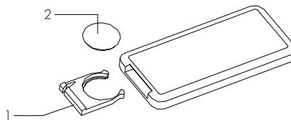
Verwenden Sie eine Lithium/Mangan-Knopfzelle, Modell-Nr. CR2025 -3 V (mitgeliefert), konform mit Batterierichtlinie Nr. 2006/66/EG und Änderungen durch Richtlinie 56/2013/EU.
