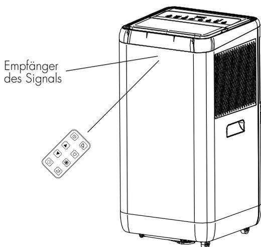
Achten Sie darauf, die Fernbedienung auf den Signalempfänger zu richten, der sich an der Vorderseite des Geräts befindet, wie in der Abbildung gezeigt.
