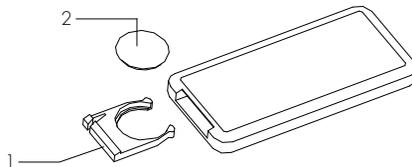
Utilizzare una pila a bottone Litio/Manganese, modello no. CR2025 -3 V (fornita), conforme alla Direttiva Batterie no. 2006/66/CE e modifiche da Direttiva 56/2013/UE.
