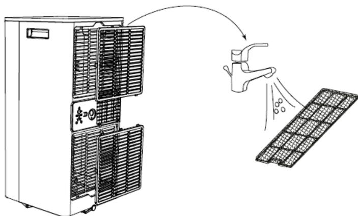
Les filtres à air doivent être contrôlés au moins une fois toutes les deux semaines de fonctionnement. Le fonctionnement de l'appareil avec des filtres sales ou obstrués entraîne inévitablement une diminution de l'efficacité du climatiseur et peut provoquer de sérieux dommages.
