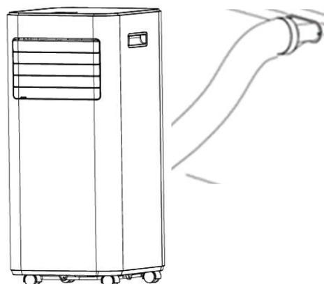
Pendant les périodes de non-utilisation, débrancher le tuyau et fermer le hublot avec le bouchon.
