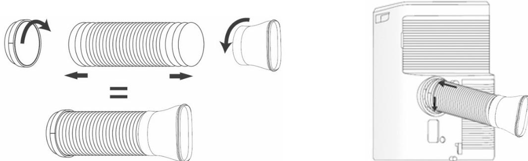
2. Alinee el racor plano del tubo con el orificio de salida de aire y engánchelo girándolo en el sentido de las agujas del reloj.
