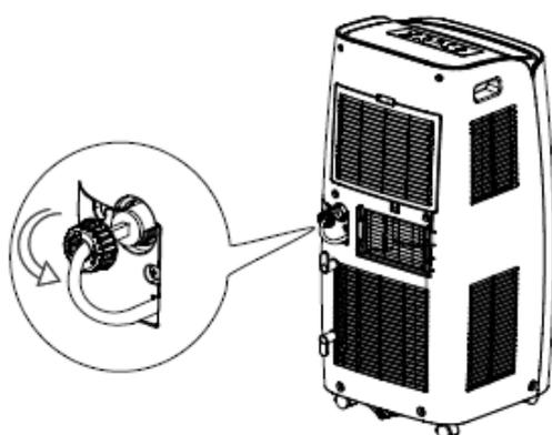
1. Retirez le capuchon en le tournant dans le sens inverse des aiguilles d'une montre.
