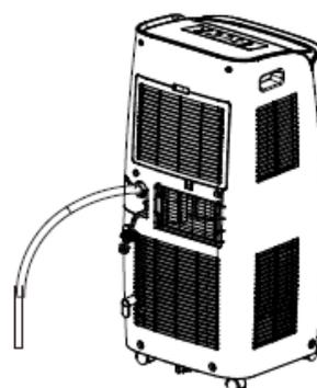
4. Insérez le tuyau de vidange dans le tube de raccordement.
