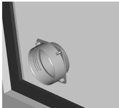
4. Insérer le raccord circulaire sur le tuyau flexible.
