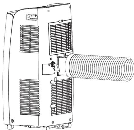
Raccorder à la partie finale du tuyau flexible le raccord circulaire pour fenêtre (1) puis le raccord terminal pour fenêtre (2), ainsi obtenu en réunissant les parties A et B
