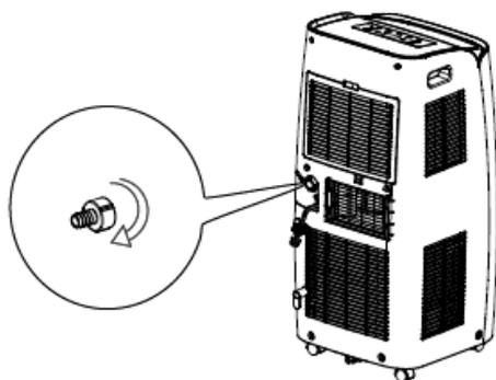
3. Visser le tube de raccordement fourni dans l'emballage en le tournant dans le sens des aiguilles d'une montre.
