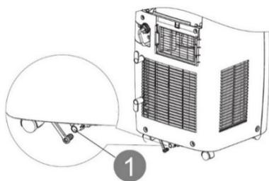
Lorsque l'appareil fonctionne en mode refroidissement et chauffage, vérifier que le bouchon en caoutchouc de fermeture de l'orifice d'évacuation situé à l'arrière de l'appareil est correctement positionné.
