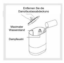
Schließen Sie das Netzkabel an das Netzteil an und prüfen Sie, ob das Netzteil dem auf dem Typenschild angegebenen entspricht. Um den Netzschalter herum leuchtet eine rote LED auf. Drücken Sie zu diesem Zeitpunkt den Knopf und die Zerstäubung beginnt und der Dampf beginnt zu entweichen. Drücken Sie den Filterkasten nach innen und lösen Sie ihn, um ihn herausziehen zu können. Installieren Sie dann den Filterkasten und den Rest des Geräts auf die gleiche Weise neu.
