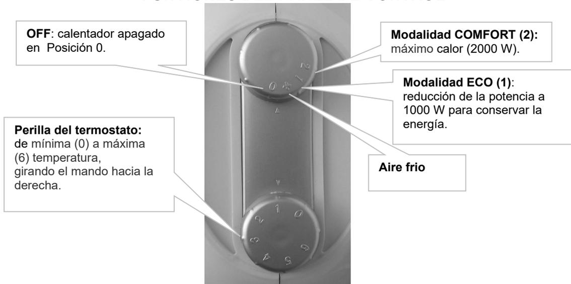
El termostato mantiene la temperatura deseada de la habitación encendiendo y apagando el aparato automáticamente. Cuanto más se gire la perilla el mando del termostato en sentido de las agujas del reloj, más alta será la temperatura mantenida.
