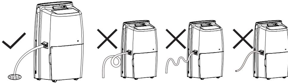
Verificare periodicamente che l'adattatore e il tubo di scarico siano strettamente collegati e non danneggiati, né bloccati.
