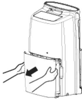
2. Prüfen Sie die Position des Schwimmers im Behälter: Nach dem Transport ist dieser möglicherweise nicht in der richtigen Position. Er muss vor der Inbetriebnahme in die richtige Position gebracht werden.
