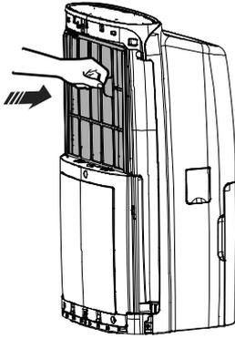
**3. Den Filter wieder einsetzen, indem Sie die unteren Haken in die Einheit einfügen und achten Sie dabei auf die Kennzeichnung „UP“, schieben Sie den Filter nun nach unten, bis ein leichtes Geräusch zu hören ist.**
