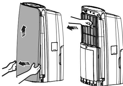
La fonction du filtre est de filtrer la poussière ou la saleté présente dans l'air. Si le filtre est obstrué par la poussière, la consommation électrique sera supérieure à la normale.
