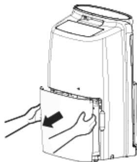
2. Vérifier la position du flotteur dans le réservoir : après le transport, la position pourrait ne pas être la bonne. S'il n'est pas correctement placé, le remettre en place avant de l'utiliser.
