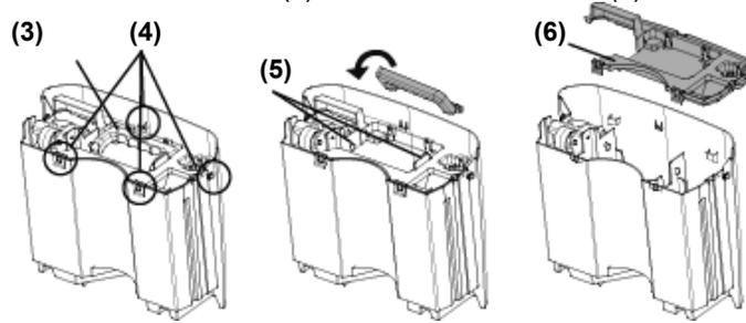
4. Après le nettoyage, remettre le couvercle et vérifier que le flotteur est correctement positionné.
