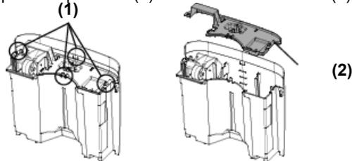
3. Après le nettoyage, remettre le couvercle et vérifier que le flotteur est correctement positionné.
