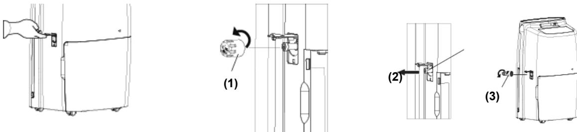
Ouvrir la trappe qui recouvre l'orifice de drainage sur le côté du déshumidificateur.
