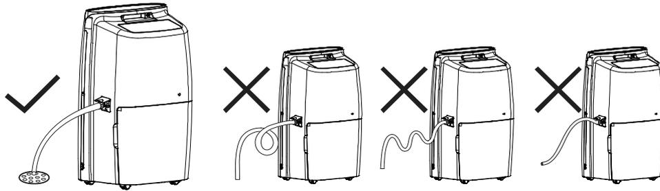
Vérifier périodiquement que l'adaptateur et le tuyau d'évacuation sont bien raccordés, non endommagés ou bloqués.
