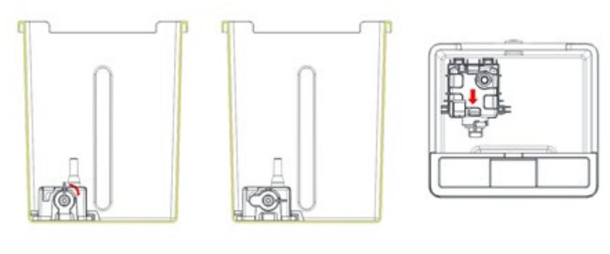
Füllen Sie demineralisiertes Wasser direkt in den Wassertank. Füllen Sie den Tank bis zur angegebenen Höchstgrenze. Der Wasserstand kann durch ein transparentes Fenster auf der Vorderseite des Geräts angezeigt werden.
