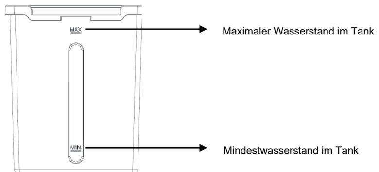
Sobald der Tank gefüllt ist, setzen Sie ihn wieder in seinen Sitz und positionieren Sie die Blöcke neu.
