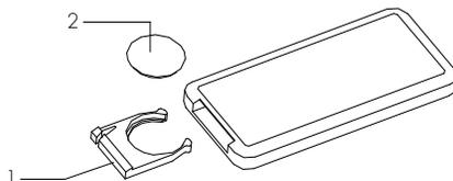
Utilisez une pile bouton au lithium/manganèse, modèle no. CR2025 -3 V (fourni), conforme à la directive sur les piles no. 2006/66/CE et modifications par la directive 56/2013/UE.
