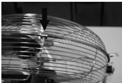
4. Vuelva a colocar la rejilla en el ventilador mediante la fijación del gancho superior firmemente a las barras de la rejilla como se muestra por la flecha.
