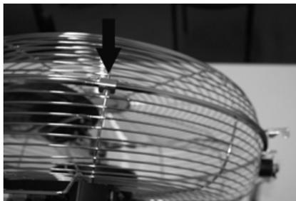
4. Remettre en place la grille sur le ventilateur en fixant fermement le crochet supérieur aux barreaux de la grille, comme indiqué par la flèche.
