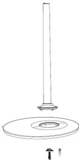
1. Utilice el tornillo de la base para fijar la base a la varilla inferior.
