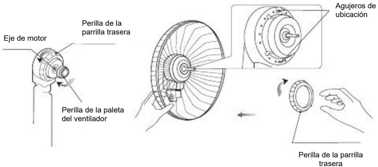
Alinee la ranura del ventilador con la barra en T del eje del motor para permitir el posicionamiento correcto, asegure el ventilador en su ubicación, apretando suavemente la tapa del ventilador con las manos y girándola en sentido antihorario hasta que esté completamente acoplada al eje del motor.
