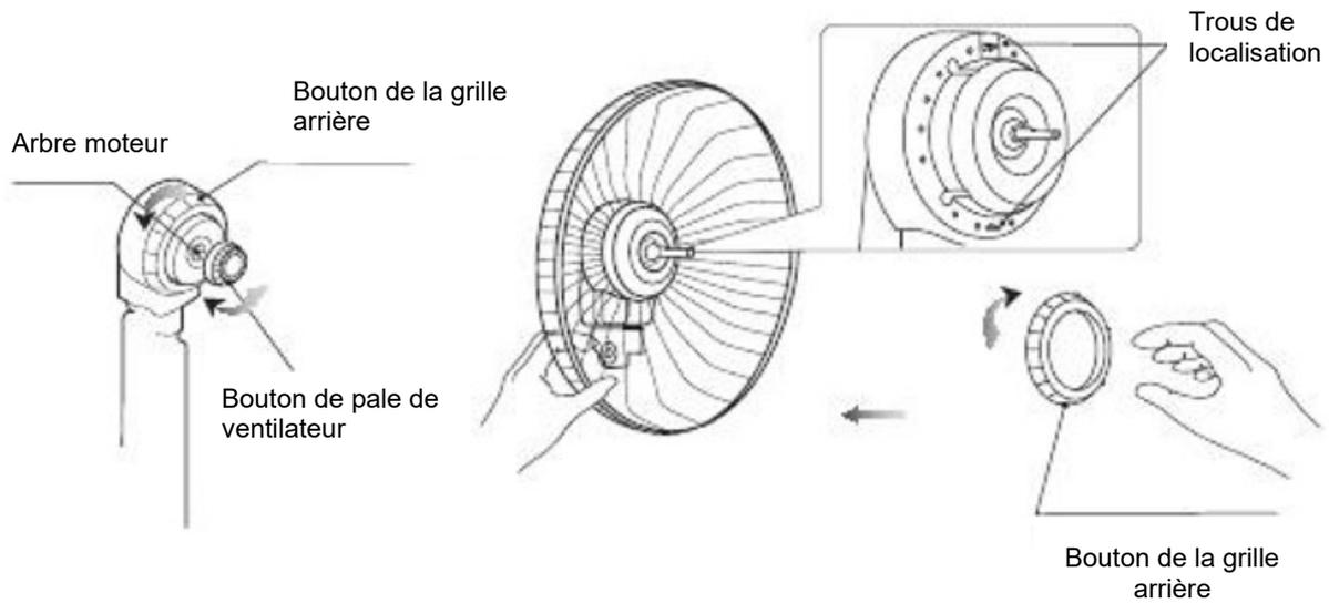
Alignez la rainure du ventilateur avec la barre en T de l'arbre du moteur pour permettre un positionnement correct, fixez le ventilateur à son emplacement, en pressant doucement le couvercle du ventilateur avec vos mains et en le tournant dans le sens antihoraire jusqu'à ce qu'il soit complètement attaché à l'arbre moteur.
