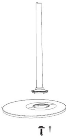
1. Utilisez la vis de base pour fixer la base à la tige inférieure. Fixez fermement les deux pièces.
