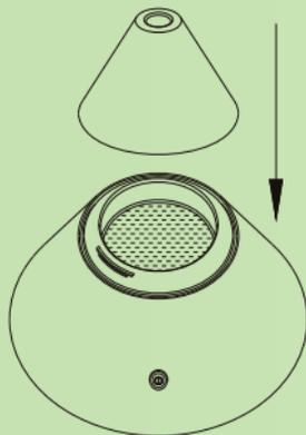
4. Replacer le cône d'émission à sa position.
