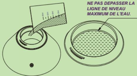
2. Remplir le réservoir d'eau propre (80 ml max.).
