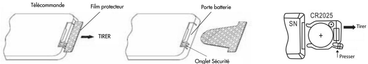
Utilisez une pile bouton Lithium/Manganèse, modèle no. CR2025 -3 V (fourni), conforme à la directive piles n° 2006/66/CE et modifications par la directive 2013/56/UE.
